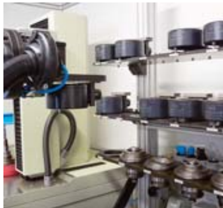
Aus dem Magazin mit Spulenkörpern (oben) und Werkzeugaufnahmen (unten) greift sich...
