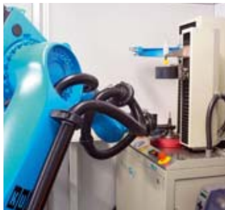
Das eingeschrumpfte und vermessene Werkzeug wird vom Roboter entnommen, in eine...
