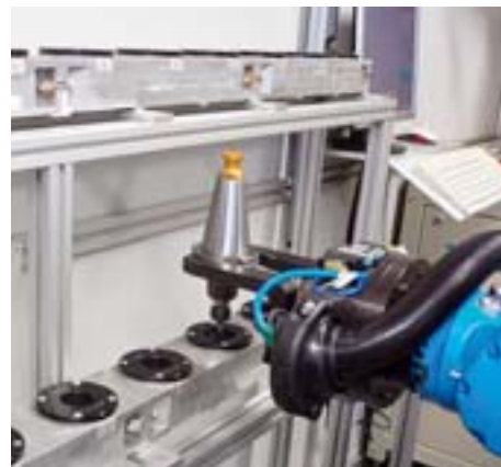
... der Kühlstationen gesetzt und danach zur Kontrollmessung in das ISVG4200PR abgelegt
