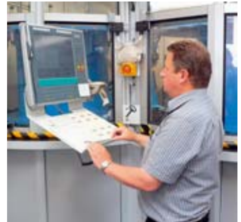
Ein- und Ausgabeplatz an der Schrumpfanlage
