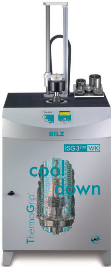
4 Zehnmal effektiver kühlen: Das Schrupf- und Kühlgerät ISG3200WK steht für hohe Bediensicherheit, die Loslösung von der Konturbindung beim Kühlen und den schnellen Werkzeugwechsel unter 30 Sekunden
