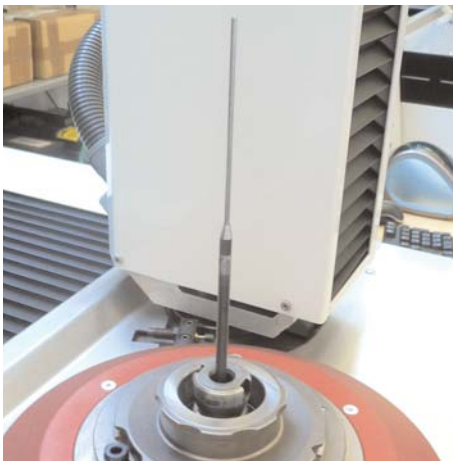
Ausgefahrener Positionierstößel zum Antasten eines langen dünnen Werkzeugs
