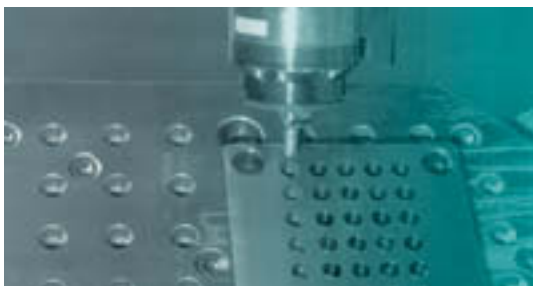
Einsatz eines formbore-Systemwerkzeugs auf einem Bearbeitungszentrum, Steilkegel 40, DIN 69871, Form A.
