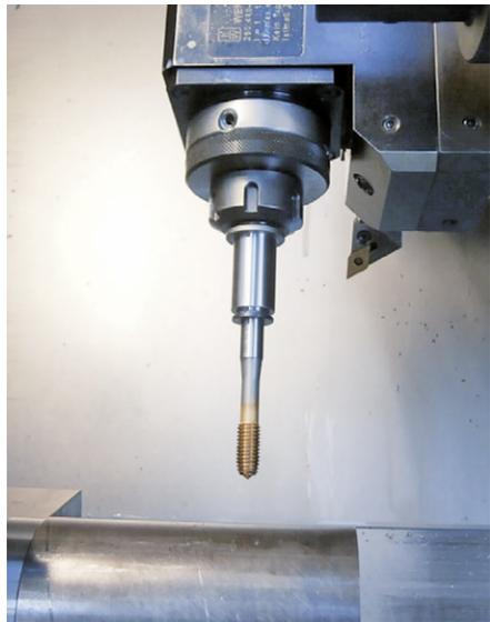
Der neue STA Synchroeinsatz (Synchro Tapping Adaptor) wurde speziell für Spannzangenaufnahmen entwickelt und ermöglicht Gewinden und Formen auf Maschinen mit synchronisierter Spindel.
