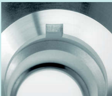
Passfedernut SW 8 mm, Tiefe 20 mm keyway SQ 8 mm, depth 20 mm
